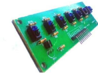
**Fig. 2: IR Reflectance Sensor Array**
